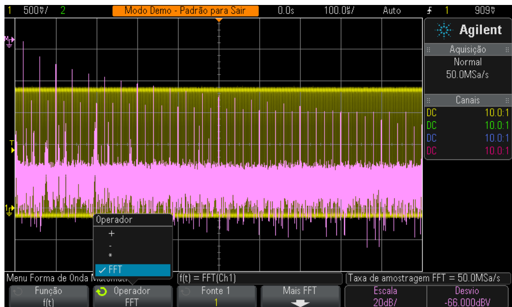
Figura 43 Executando uma função matemática FFT em um clock digital repetitivo
