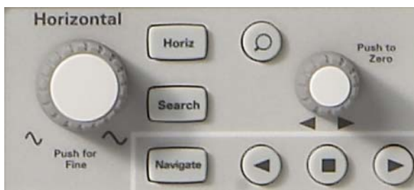
Figura 4 Controles horizontais do osciloscópio (eixo X)
