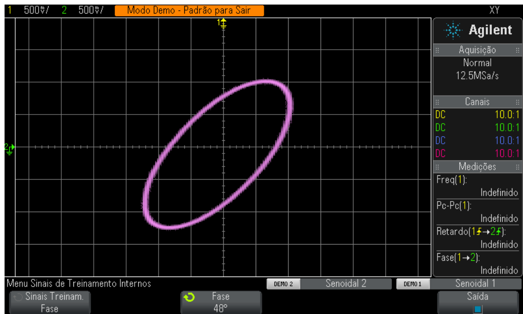
Figura 40 Um padrão de Lissajous usando o modo XY do osciloscópio de duas ondas senoidais da mesma frequência, mas 48 graus fora de fase em relação à outra.
