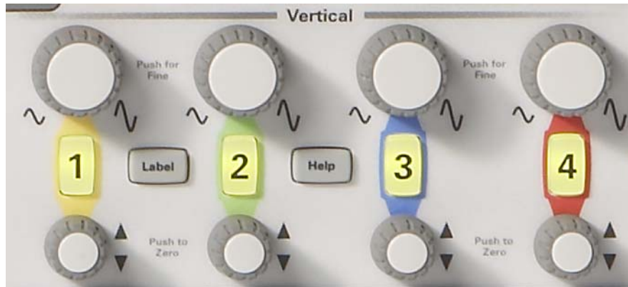
Figura 5 Controles verticais do osciloscópio (eixo Y)
